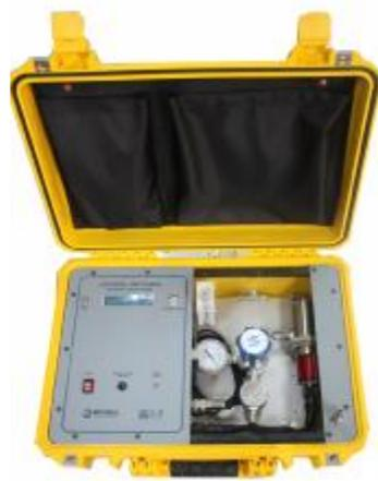
该产品为一套完整的便携式水露点测量系统，将冷镜式露点仪及预处理系统集成在一起，将所有的经验和专业技术综合浓缩成一体，成为一款满足客户现场测量、显示、计量标准等方面要求的便携的冷镜式精密水露点分析系统，采用电池供电，非常适用于天然气现场的露点测量。
